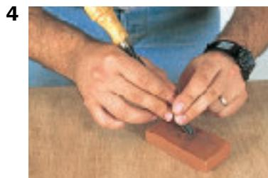
4. Pour affûter une gouge creuse, procéder comme pour un ciseau, en ayant un mouvement de rotation pour suivre la forme de la gouge.
