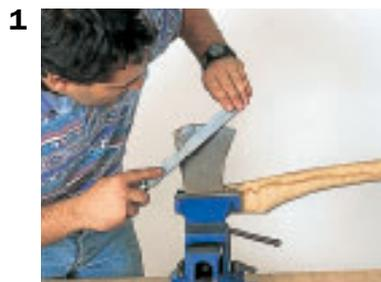
1. Aiguiser une hache ou une hachette à la lime plate, en respectant l'angle d'origine du tranchant.
